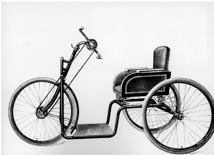
Petri und Lehr, ca. 1925, Kurbelvorderradantrieb mit Kettenübertragung
