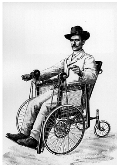
Rollstuhl-Kurbelantrieb, Palmirani, Bologna, 1908, Doppelseitiger Kurbelantrieb mit Kettenübertragung
